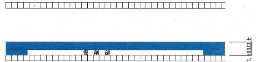
※縦断占用の場合、最低舗装幅1.5m以上とし敷均しは、アスファルトフィニッシュ施工とする。
